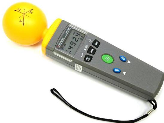
Рис. 1. Измеритель электромагнитного поля АТТ-2592
